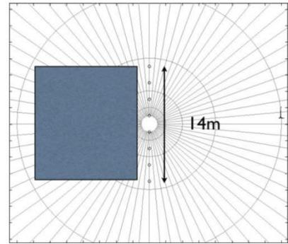
Tomando como punto de partida el ejemplo anterior; colocamos los subs a una distancia de 1,70 entre sí y aplicamos los siguientes delays;
