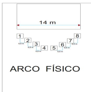
Esta configuración es cada vez más utilizada, logra una cobertura muy homogénea, un buen nivel en la zona del público y una importante disminución en la zona del escenario, su comportamiento es muy bueno en combinación con sistemas Line Array.
