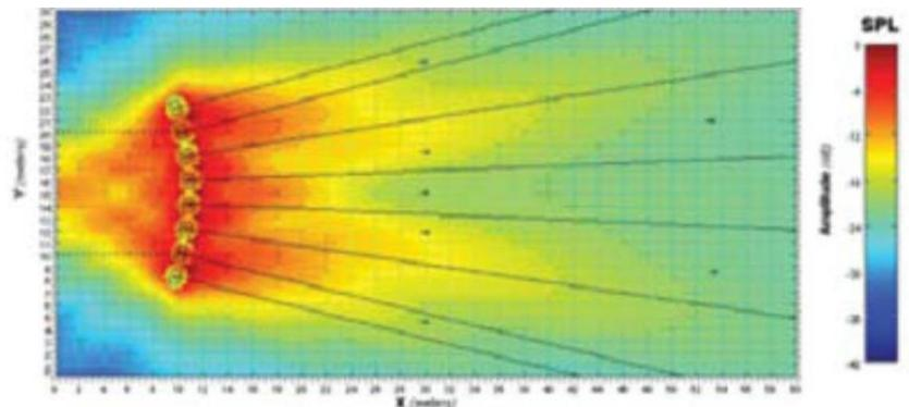
Como podemos observar, hemos ganado cobertura general con respecto a la configuración en línea horizontal, pero tenemos una leve reducción de nivel en la zona central, esto puede solucionarse colocando un subwoofer encima del sub nº 4 y otro encima del sub nº 5, recuperando así el nivel en la zona central.
