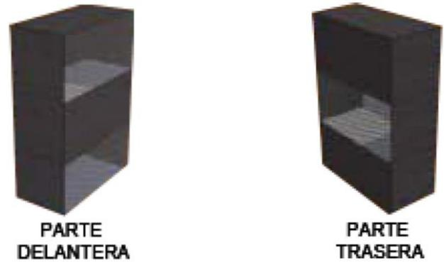
Después conectamos el subwoofer en posición invertida y desconectamos los otros dos subwoofers, tomaremos otra referencia y lo ajustaremos en fase aplicándole el delay correspondiente (aproximadamente 3 ms), por último, aplicaremos un cambio de polaridad al subwoofer en posición invertida.
