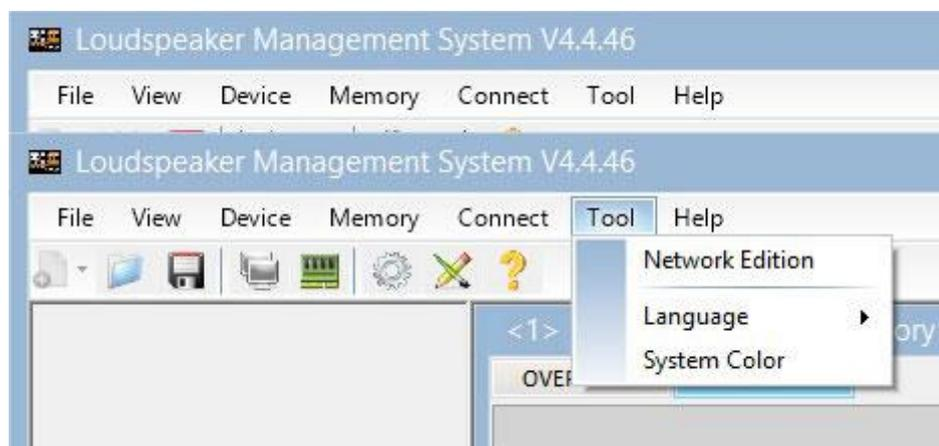
Al disponer de una red de sistemas conectados entre sí mediante cableado Ethernet y protocolo RS485, usted tiene la posibilidad de **crear un grupo de sistemas**, lo cual permite que cualquier cambio o actualización realizada sea aplicado en todas las unidades que forman parte de la misma red.
