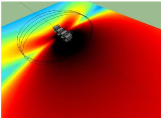
Comportamiento del lóbulo tras aplicar el delay electrónico
