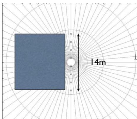
Una vez colocados los subs a 1,70 m uno del otro veremos el comportamiento de distintas frecuencias en distintos grados, tomando como referencia el eje central. Para observar la relación de fase existente en grados utilizaremos la fórmula;
